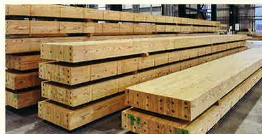
何枚もの板を重ねて出来上がる集成材。現場ですぐ組み上げられるよう事前加工するプレカット済みで、原木からプレカット加工まで一貫生産することで建材費のコストダウンも図る
