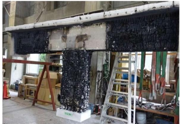
写真 4：耐火部材による接合部性能実大燃焼試験
