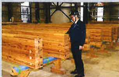
ウッドコアの工場で製造されている大阪・関西万博の大屋根の梁材
