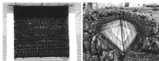
写真3.3-1 耐火構造梁の断面拡大試験
