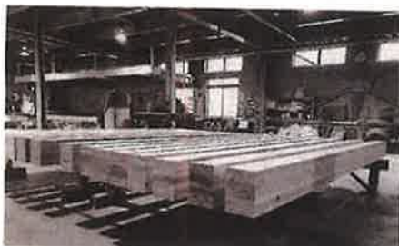
昨年開発の杉を使った高強度集成材。部材開発にも積極的に取り組む
